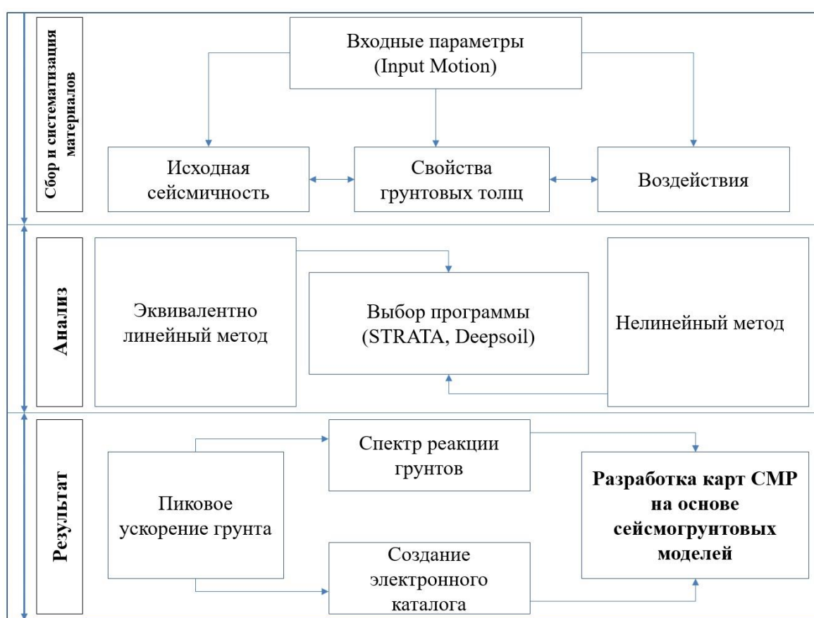
Рис. 1. Алгоритм действий разработки сейсмогрунтовых моделей.
